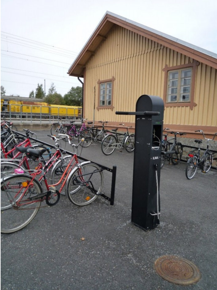
Kuva 37 Esimerkki polkupyörien huoltotolpasta Vammalan rautatieasemalta Sastamalasta 2018. Tolppa sisältää pyörän kannatintelineen, vaijerilla kiinnitetyt työkalut ja jalkakäyttöisen ilmapumpun.
